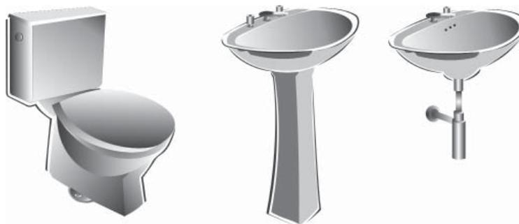
Figura 100 Tipos de vaso sanitário e lavatórios
