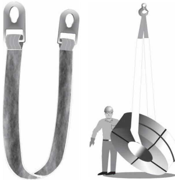
Figura 37 1) Cinta de poliéster para elevação de cargas.
