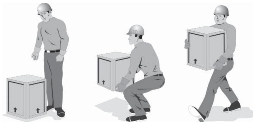
Figura 70 Técnica de levantamento de peso
