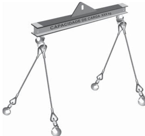
Figura 19 Marcação de carga máxima
